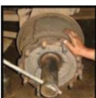
Com uma chave de soquete, retire a porca da ponta de eixo e a arruela de encosto, liberando assim o cubo de roda para ser sacado.
