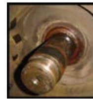
Logo após, com o cubo já fora do veículo realize uma limpeza geral do conjunto antes de iniciar a desmontagem do rolamento danificado. Nesta etapa, a ponta de eixo deverá também ser limpa verificando se a superfície do alojamento do rolamento e rosca não estão danificadas. Após esta limpeza e verificação, pano ou jornal, envolva a ponta de eixo para que não receba impurezas até a montagem do cubo no novo rolamento.
