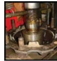
Toda a montagem deve ser realizada na ordem inversa da desmontagem citada anteriormente. A montagem do novo rolamento na prensa deve ser realizada do lado de fora da roda para dentro (roda para eixo). Este rolamento tem posição de montagem onde o lado que tem a aba sobressalente fica montada para lado externo. Durante todo o processo de montagem certifique-se que o rolamento esteja livre.
