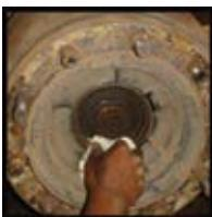
Faça a limpeza da ponta de eixo e do tambor, retirando toda a oxidação e fuligem do desgaste, com cuidado para não danificar a rosca da ponta de eixo
