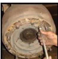
Com uma chave "L", retire o parafuso de fixação do tambor de freio, liberando assim para ser sacado.
