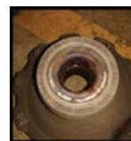
Ao sacar o cubo de roda da ponta de eixo não utilize martelo ou marretas, principalmente nas "orelhas" do cubo de roda, pois é fabricado em ferro fundido, um material frágil a impactos podendo quebrar. Utilize um saca polia ou um macaco hidráulico para realizar esta operação.
